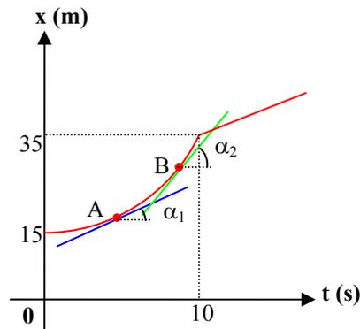
**Figura 15.** O gráfico  $x \times t$  representando o movimento de um corpo ao longo de uma trajetória retilínea.
