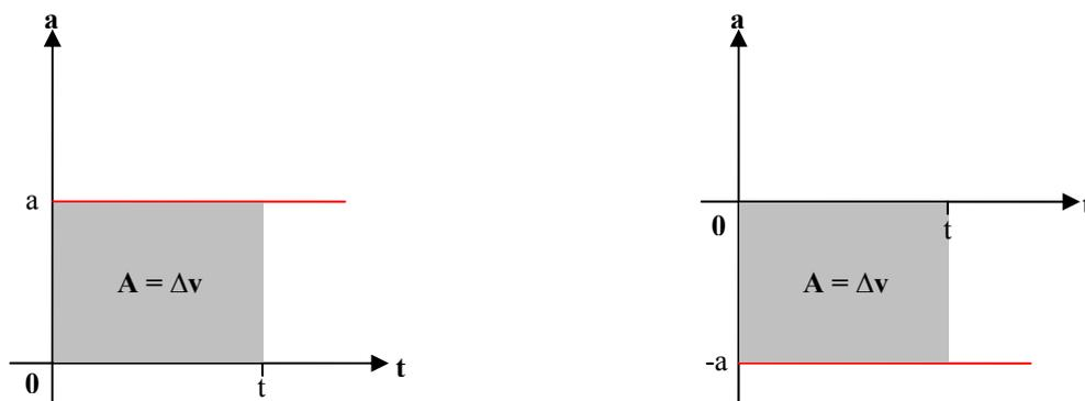
**Figura 12.** À esquerda, o gráfico  $a \times t$  representando um MRUV com aceleração positiva. À direita, o gráfico  $a \times t$  representando um MRUV com aceleração negativa.
