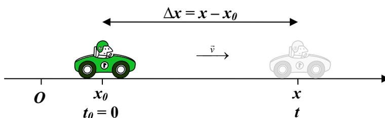
**Figura 4.** Uma representação esquemática do movimento de um carro, com velocidade constante, numa trajetória retilínea.
