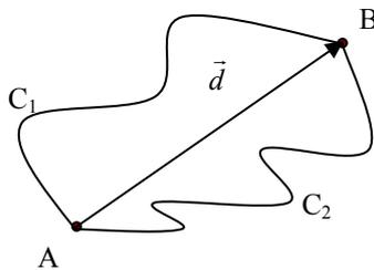
**Figura 2.** O deslocamento  $\vec{d}$  de um corpo ao percorrer as trajetórias  $C_1$  e  $C_2$ , entre os pontos  $A$  e  $B$ .
