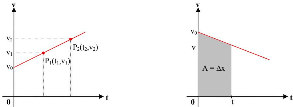
**Figura 10.** À esquerda, o gráfico  $v \times t$  representando um MRUV com velocidade positiva. À direita, o gráfico  $v \times t$  representando um MRUV com velocidade negativa.
