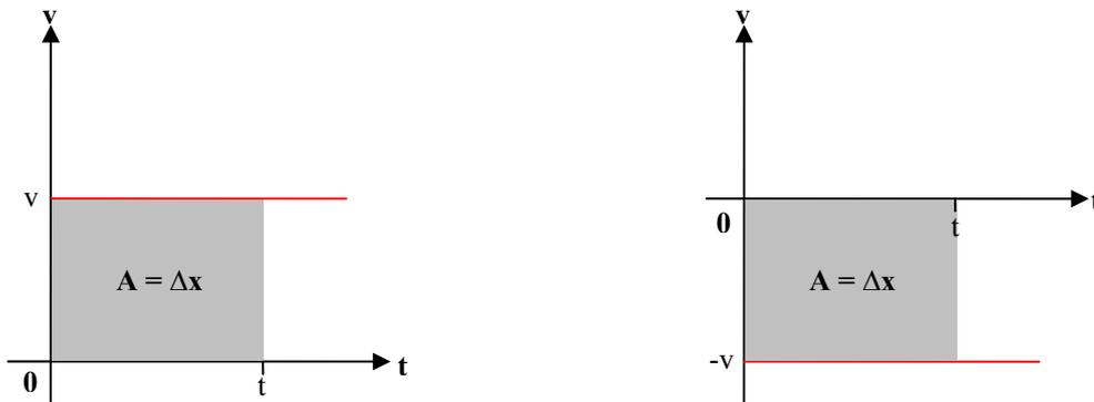
**Figura 8.** À esquerda, o gráfico  $v \times t$  representando um MRU com velocidade positiva. À direita, o gráfico  $v \times t$  representando um MRU com velocidade negativa.
