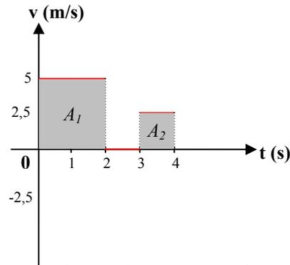
**Figura 9.** O gráfico  $v \times t$  representando o movimento de um corpo ao longo de uma trajetória retilínea.
